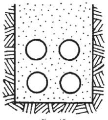
Figure 1.2 Direct Burial Conduit Bank
